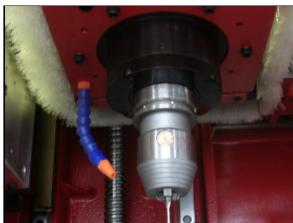
Hauptfrässpindel mit eingesetztem NC-Bohrfutter.
