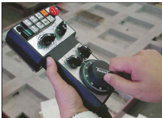
Handbedienpanel (Remonte-Control) für mehr Effizienz im Einricht- und Kontrollmodus
