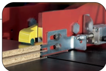
Zuschnitt für überstehende Deckschichten mit automatischer Formateinrichtung
