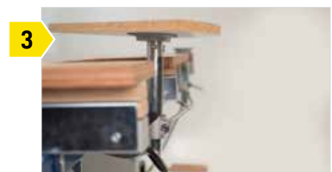
3 Bei Bedarf ist die Vakuum-Spanneinheit unter die Arbeitsplatte wegklappbar.
