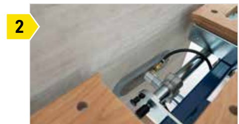
2 Vakuum-Spanneinheit mit zwei verschiebbaren Ovalgreifern mit Tastventil.
