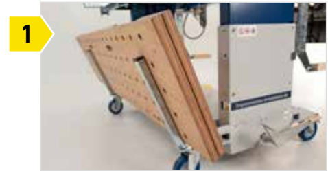
1 Auflagen hinten für das Ablegen der Arbeitsplatten.
