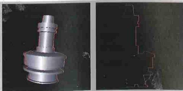
Das Rüsten der Arbeitseinheiten und der Werkzeugwechsler kann mittels grafischer Bestückung mit Hilfe der Maus durchgeführt werden. Es besteht die Möglichkeit jedem Werkzeug ein Formprofil in DXF zuzuordnen und daraus automatisch eine Darstellung in 3D zu entwickeln, so dass sie dem Werkzeug während der Bestückungs- und Simulationsphase zugeordnet werden kann.
