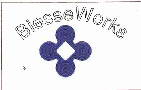
Automatische Berechnungsfunktion der Werkzeugverfahrwege zur Ausführung von Ausfräsungen jeglicher Form, mit der Möglichkeit Inseln hervorstehen zu lassen und mit verschiedenen Tiefen zu arbeiten. Die Ausfräsungen können mit konzentrischen oder parallelen Vorschüben ausgeführt werden. Des Weiteren besteht die Möglichkeit, einen Vorschub zur Kantennachbearbeitung vorzusehen.
