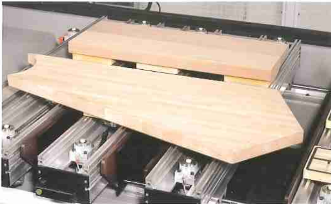
Step machining. ● Stufenbearbeitung.
