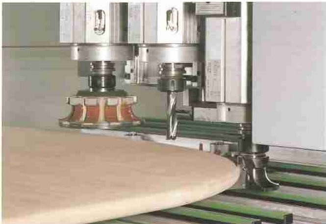
■ Profiling of the top of the table with shaped tool. ● Formung der Tischplatte mit Formwerkzeug.
