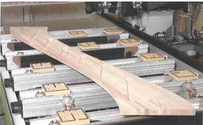
Staircase side machining. ● Bearbeitung der Treppenseite.
