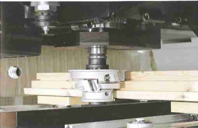
Profiling Contournage de chambrantes de portes et fenêtres
