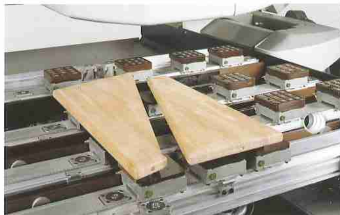
Machining of step components Façonnage de la marche
