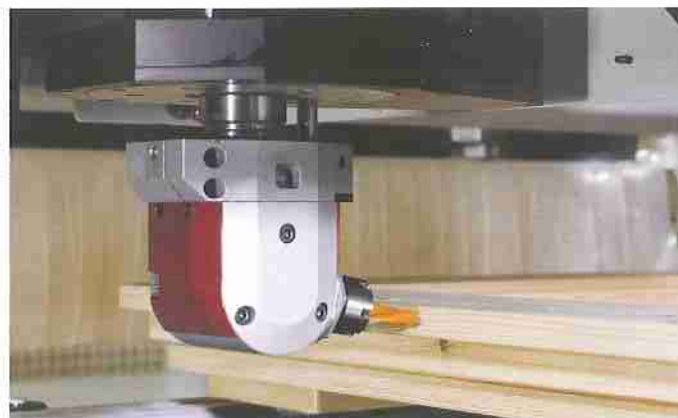
Angled boring for hinges Perçage incliné pour charnières
