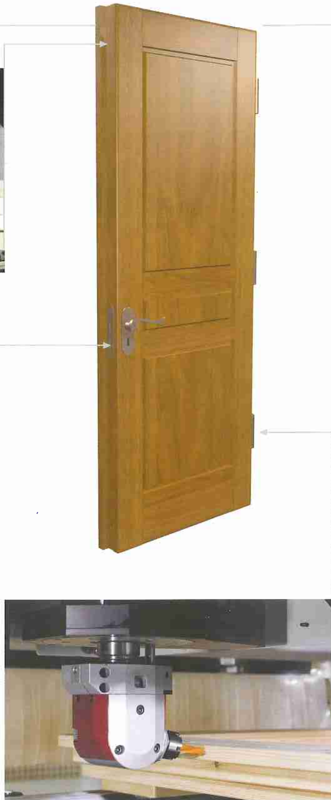
Angled boring for hinges Perçage incliné pour charnières
