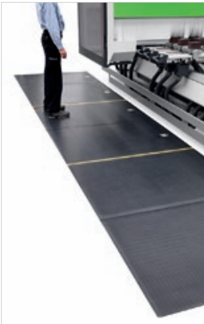
压敏性地毯保障机器以恒定的最大速度运行。
