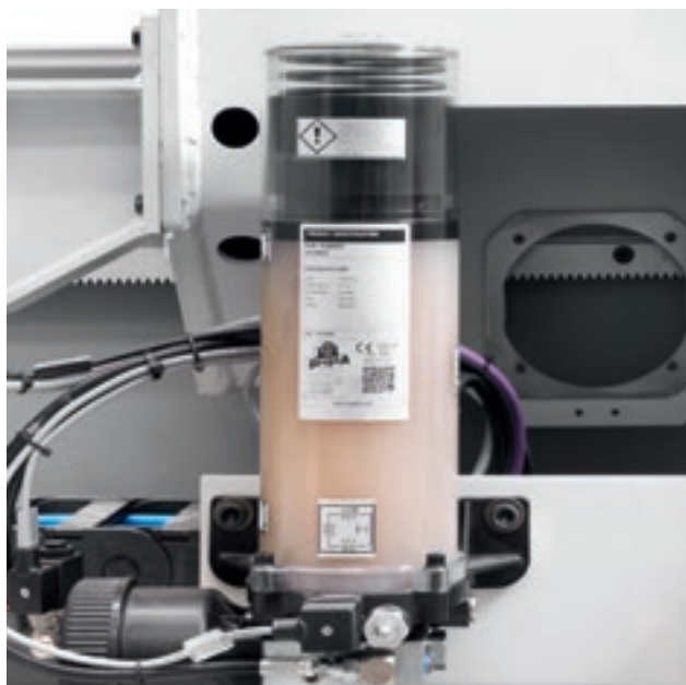
Lubrificação automática da unidade de perfuração BH29 2L.
