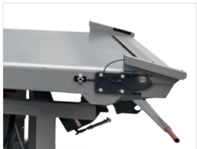
Kit aggiuntivo di aspirazione per tappeto di scarico composto da 2 cuffie di aspirazione, una posizionata sulla parte superiore del tappeto di scarico e l'altra posizionata alla fine del tappeto.
