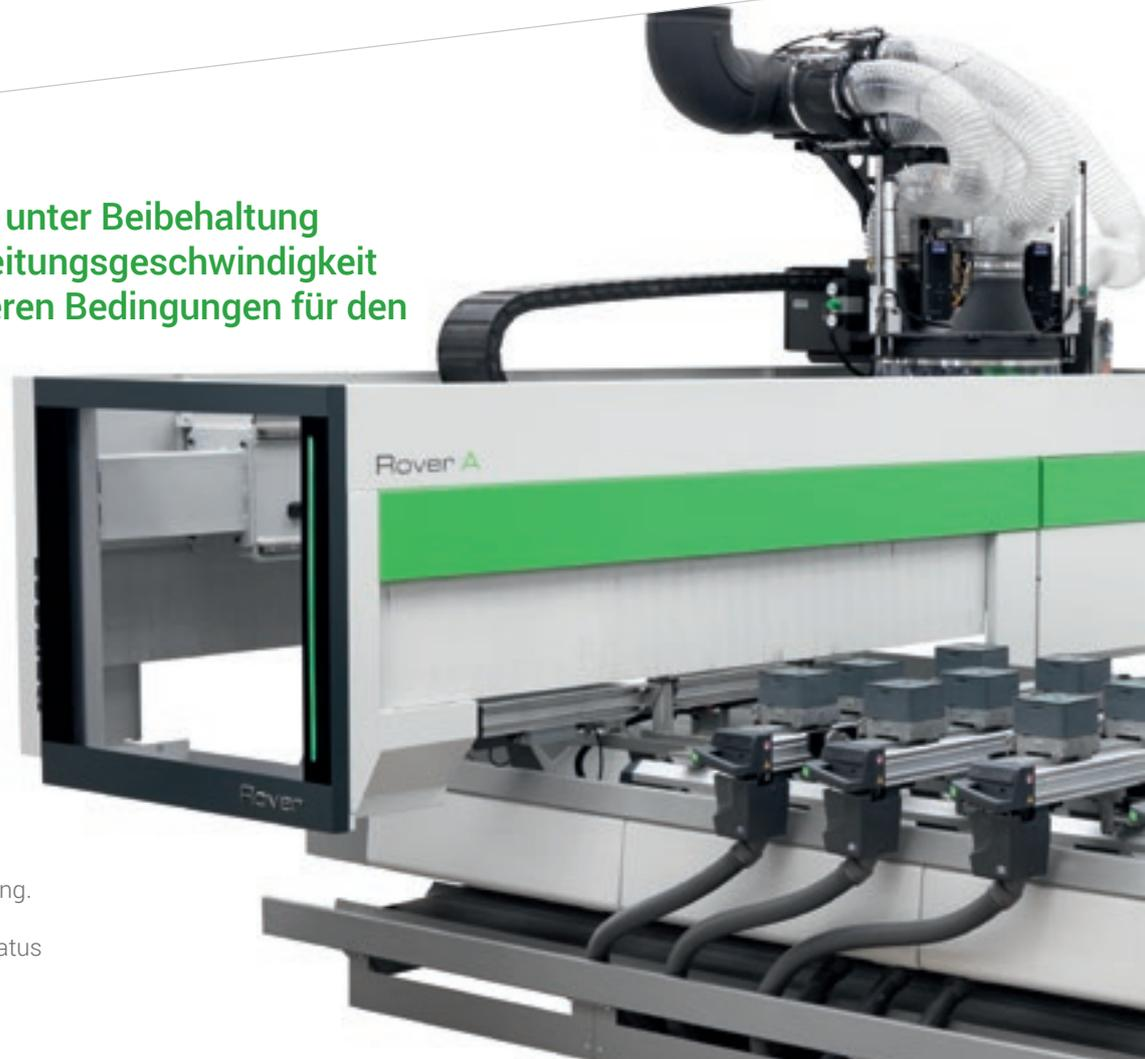
Maximale Sicht der Bearbeitung. LED-Leiste mit 5 Farben für die Anzeige des Maschinenstatus in Echtzeit.
