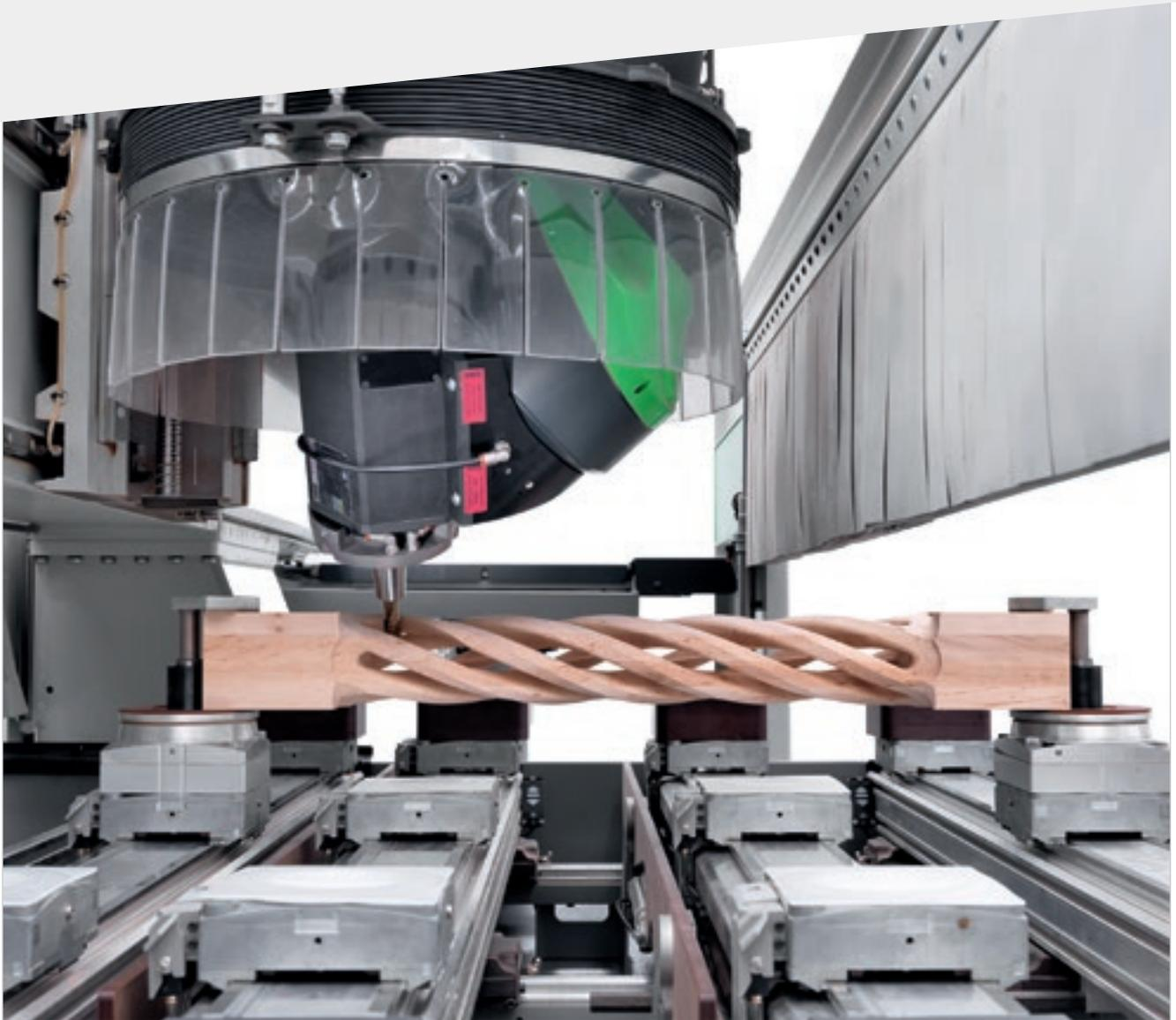
5-Achs-Fräseinheit mit um 360 mm höhenverstellbarer Saughaube.
