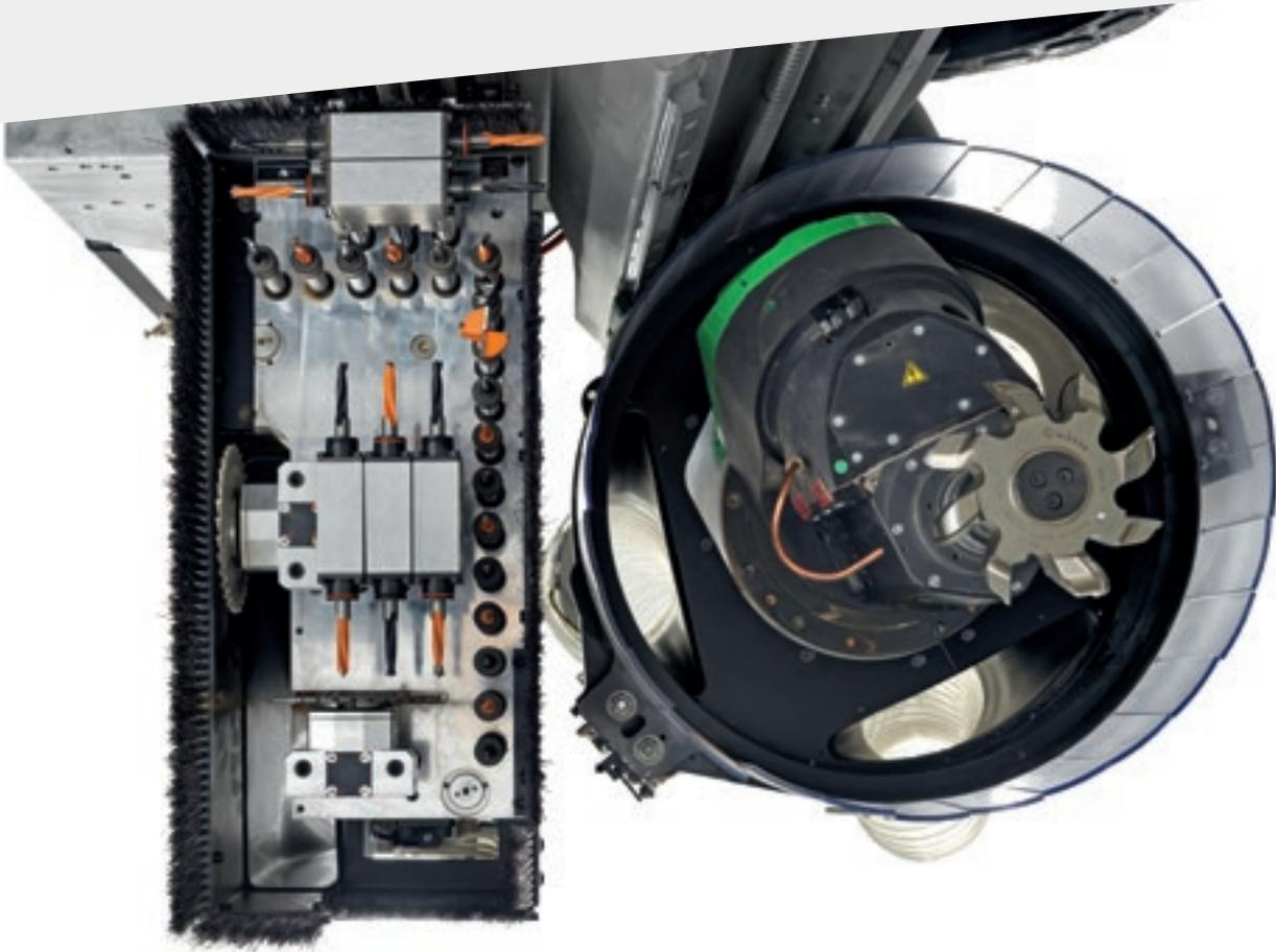
Der neue Bohrkopf BH29 2L ist mit einer automatischen Schmierung für eine noch sauberere Umgebung ausgestattet. Er ist flüssigkeitsgekühlt, um höchste Präzision zu gewährleisten.
