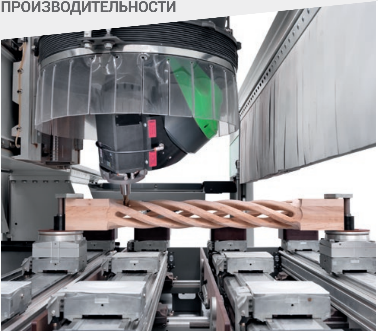
Фрезеровальная группа с 5 осями с вытяжным кожухом, регулируемым по высоте на 360 мм.
