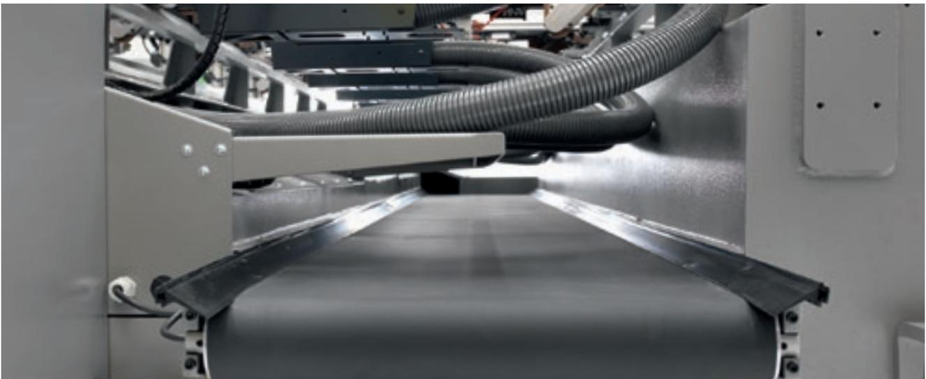
Приводной транспортер для удаления стружки и обрезков.
