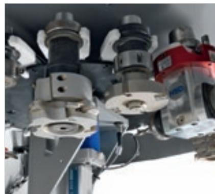
Реvolverный магазин инструментов на 16 мест на каретке X позволяет иметь инструменты и агрегаты всегда под рукой. Оснащен картером с автоматическим открытием, защищающим инструменты.
