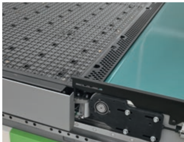
Aspirazione da sotto disposta tra la macchina e il tappeto di scarico.
