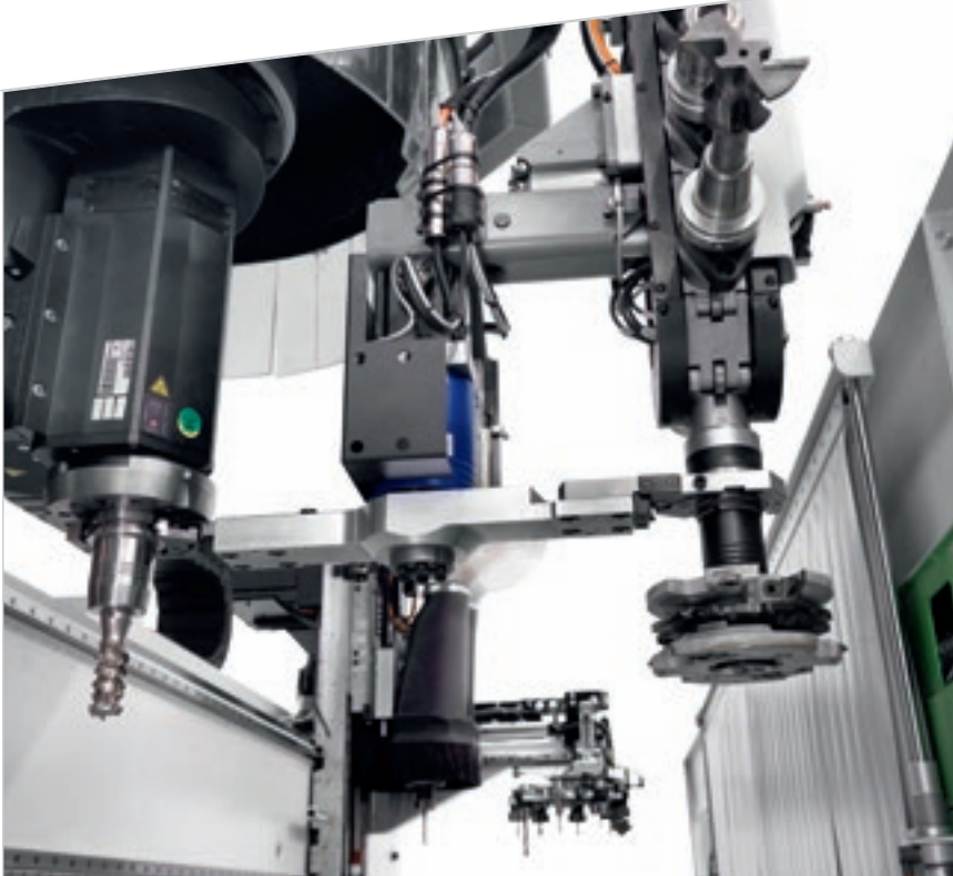
Magasin outils à chaîne verticale sur axe Y de 10-15 positions
