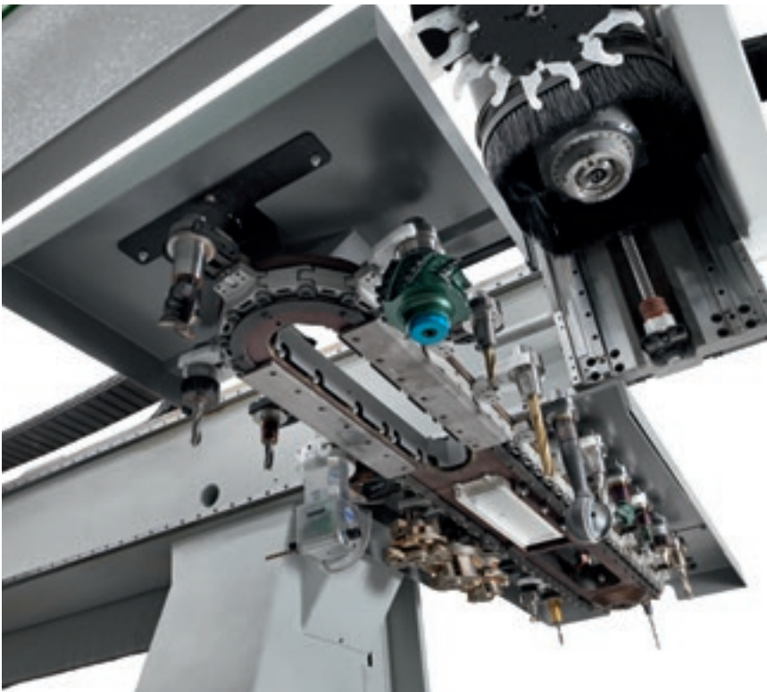
Accesso facilitato durante le operazioni di attrezzaggio grazie alla carena anteriore apribile .
