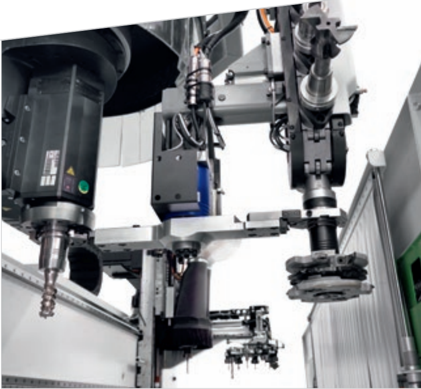
Magazzino utensili a catena verticale su asse Y da 10-15 posizioni.
