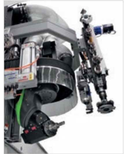
Magazzino utensili a catena verticale su asse Y da 10-15 posizioni.
