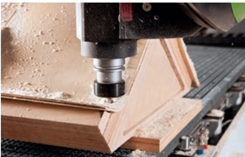
Bloqueo de piezas colocadas en contra-plantillas especiales con vacío.
