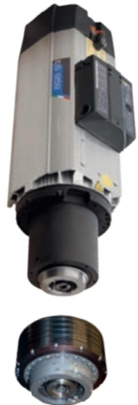
Nuovo **asse C Torque**: con sistema Direct Drive. L'assenza di ingranaggi consente massima precisione, affidabilità e rapidità d'esecuzione. La rotazione di 360° in continuo e la possibilità di interpolare permettono l'esecuzione di pezzi con forme complesse.
