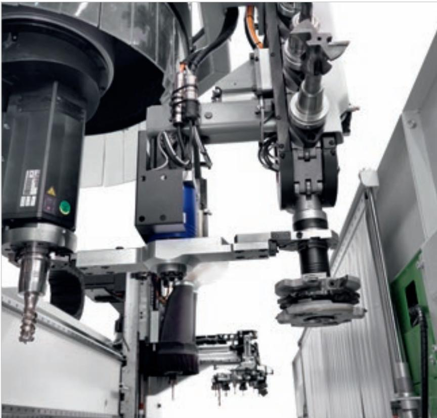
Il **Pick Up** permette di attrezzare i magazzini a bordo macchina.
