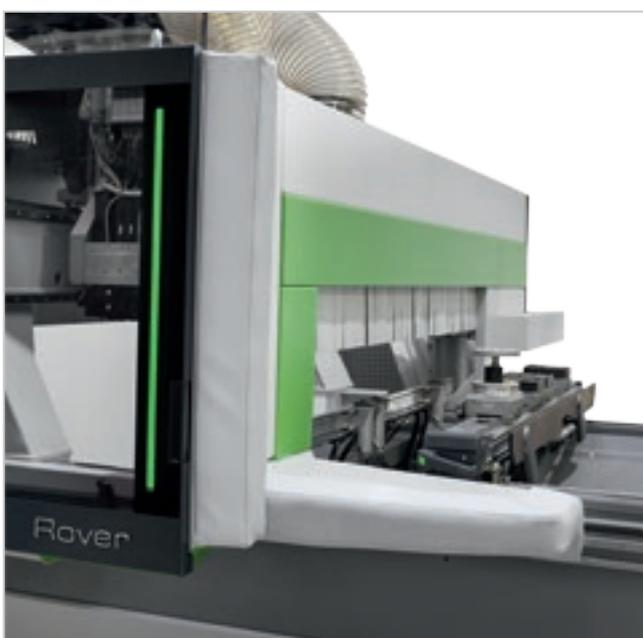
Sicurezza e flessibilità grazie ai nuovi bumper abbinati alle fotocellule senza ingombro a terra con pendolare dinamico.
