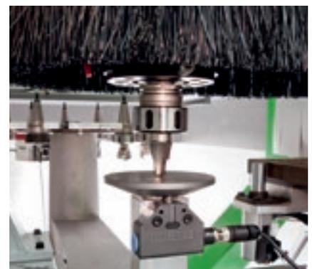
Riduzione dei tempi di attrezzaggio macchina senza errori da parte dell'operatore grazie al **Presetter a contatto** che permette di effettuare automaticamente la misurazione della lunghezza utensile.
