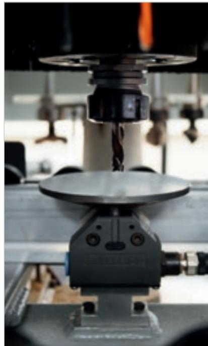
Reduzierung der Zeiten für die Maschinenbestückung, ohne Fehler von Seiten des Bedieners, dank des Kontakt-Vor-einstellgeräts, das es ermöglicht, die Messung der Werkzeuglänge automatisch durchzuführen.
