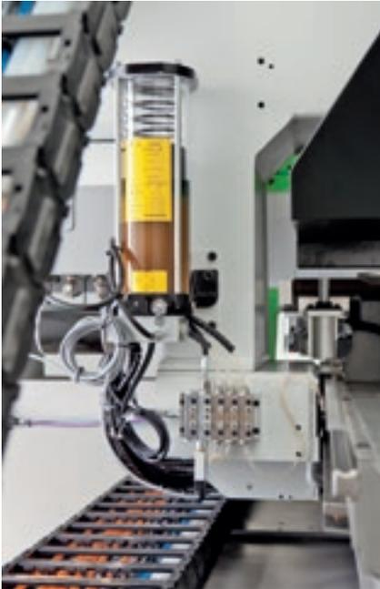
Die **automatische Schmierung** ist eine Option, die eine ständige Schmierung der wichtigsten Bewegungselemente der Maschine ohne Eingriff des Bedieners gewährleistet.
