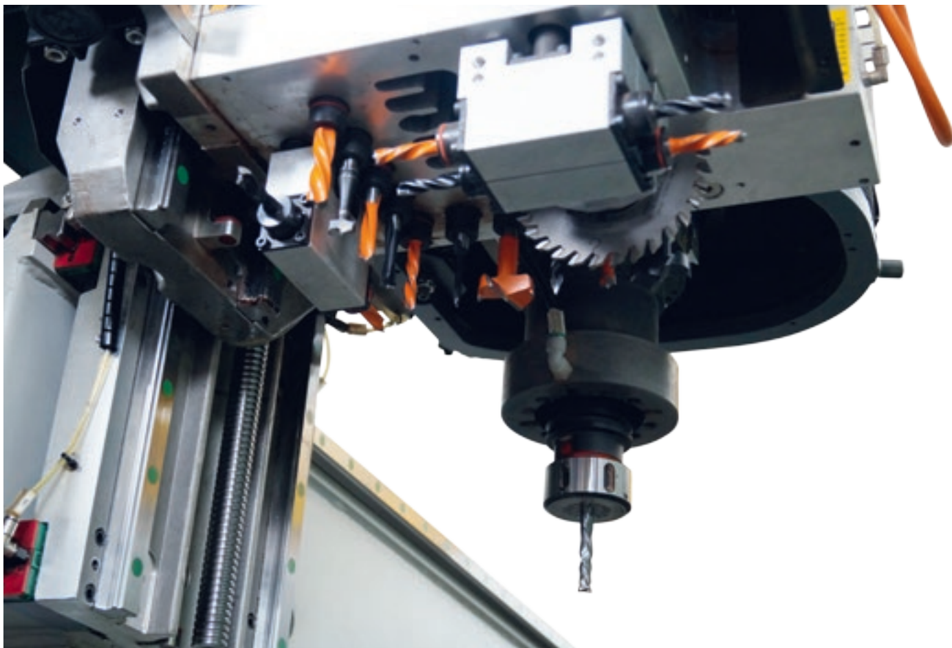
Электршпindel на 13.2 кВт.
