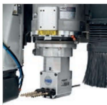
Il gruppo multifunzione posizionabile in continuo su 360° da CN, può ospitare aggregati per l'e- secuzione di lavorazioni specifiche (incasso per serratura, sedi per cer- niere, foratura orizzontale profonda, intestatura, ecc.).
