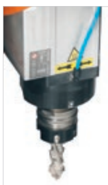
Motore verticale fisso dedicato a la- vorazioni accessorie di fresatura (slot, an- tisceggia, ...).
