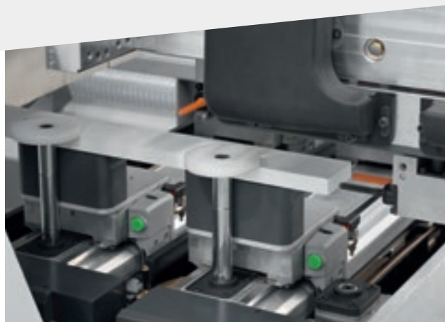
Sistema di bloccaggio Easyclamp per lavorazioni di pezzi stretti.
