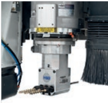
El grupo multifunción posicionado en continuo a 360° desde el CN, puede montar grupos para la ejecución de mecanizados específicos (alojamientos para cerraduras, fresados para bisagras, taladros horizontales profundos, retestado, etc.).
