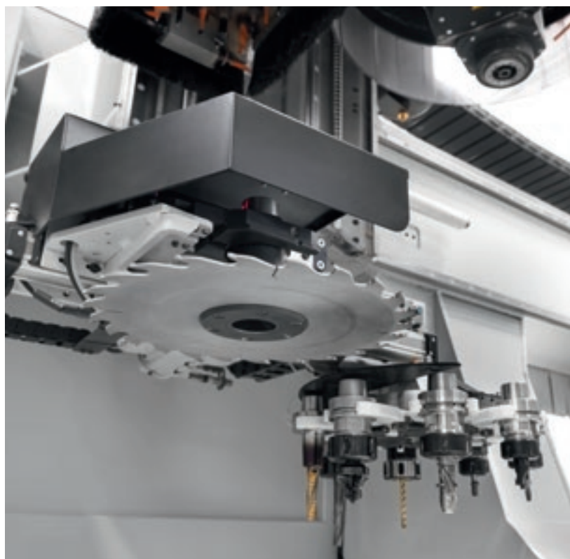
Magasin à emplacement simple et magasin outils à revolver 8 positions
