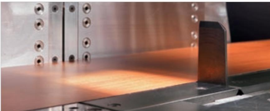
Perfecta alineación incluso de paneles muy finos y/o flexibles reduciendo al mínimo el tiempo de ciclo gracias al **tope de alineación lateral** integrado en el carro de la sierra.
