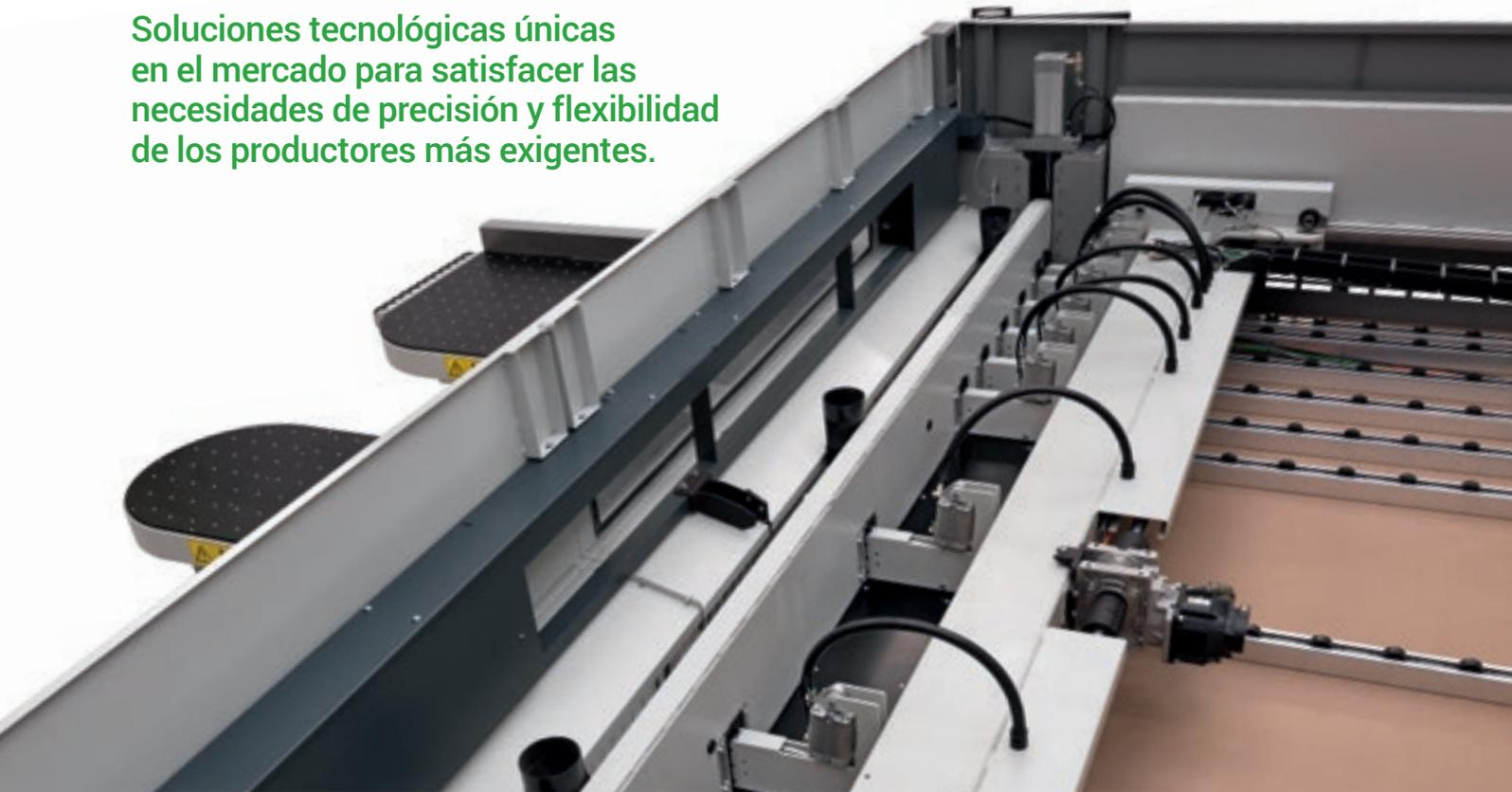
El **prensor** tiene una estructura de elemento único que permite una presión homogénea y controlada sobre el paquete de paneles que debe cortarse. La apertura se optimiza automáticamente en función del espesor del paquete de paneles para obtener la mejor calidad de corte y reducir el tiempo de ciclo.
