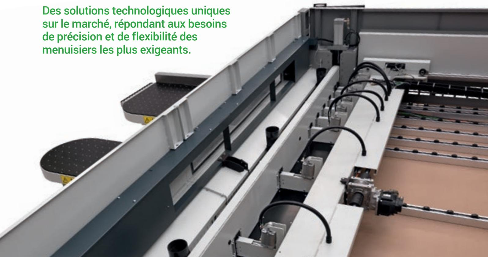
La conception à bloc unique du **presseur** assure une pression homogène et contrôlée sur la pile de panneaux à couper. L'ouverture est optimisée automatiquement en fonction de l'épaisseur de la pile de panneaux pour obtenir la meilleure qualité de coupe et réduire la durée du cycle.
