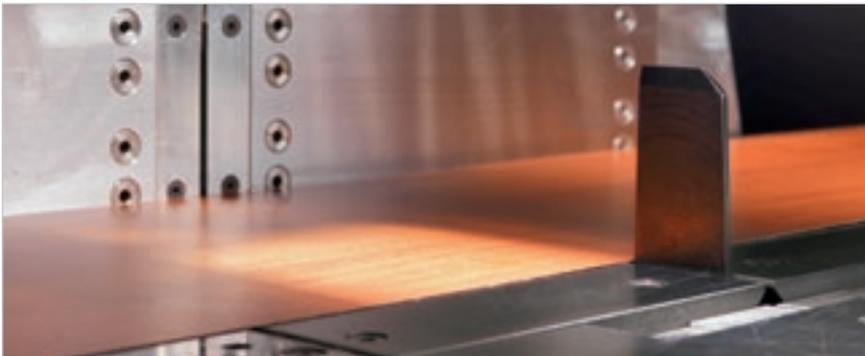
Alignement parfait de panneaux même très minces et/ou flexibles pour réduire au minimum le temps de cycle grâce à la **butée d'alignement latéral** intégrée au chariot porte-lames.
