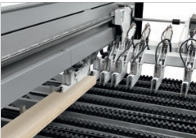
System bestehend aus zwei kompletten unabhängigen Schiebern, ermöglicht eine simultane Aufteilung von unterschiedlichen Streifengruppen. Jeder dieser Schieber kann ein komplette unabhängige Spannzangen (nicht angetrieben) verketteten, jeweils in Abhängigkeit der unterschiedlichen Breiten der Streifengruppen.
