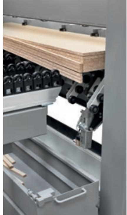
Die Besäumschnitte in Längsrichtung werden über eine komplett automatische, auf freilaufenden Rollen gleitende Schleuse ausgeworfen.
