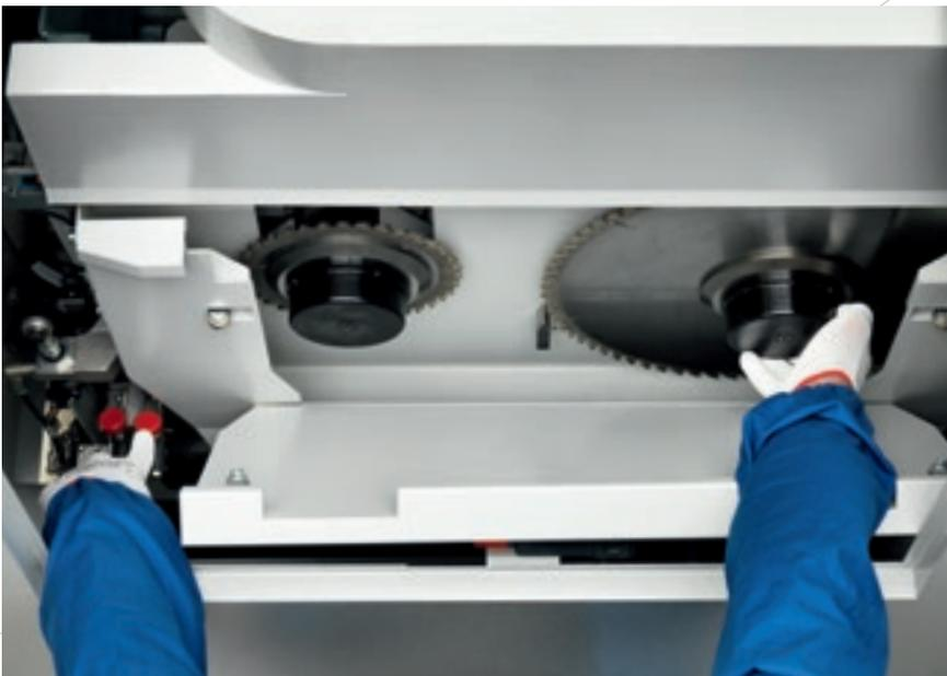
Das „Quick change“ System ist die schnellste, ergonomischste und sicherste Vorrichtung für den werkzeuglosen Sägeblattwechsel.
