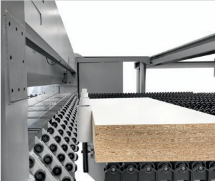
Verschlussystem der Schnittlinie, um das Herabfallen der Längsabschnitte zu vermeiden.
