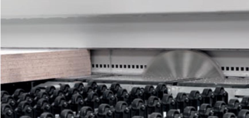
Der doppelte Druckbalken, mit zwei unabhängigen Trägern, ermöglicht da keine Öffnungen für die Spannzangen, einen gleichmäßigen, kontrollierten Andruck auf das zu schneidende Plattenpaket und erzeugt eine geschlossene dichte Kammer bei den Besäumschnitten mit daraus resultierender effizienter Staubabsaugung.
