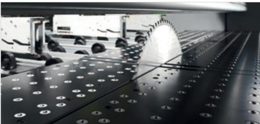
Table à coussin d'air pour le déplacement de matériaux délicats. Cette caractéristique garantit une propreté permanente de la table juste à côté de la lame.
