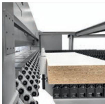
Les déchets longitudinaux sont évacués au moyen d'une trappe complètement automatique composée de roulettes libres.
