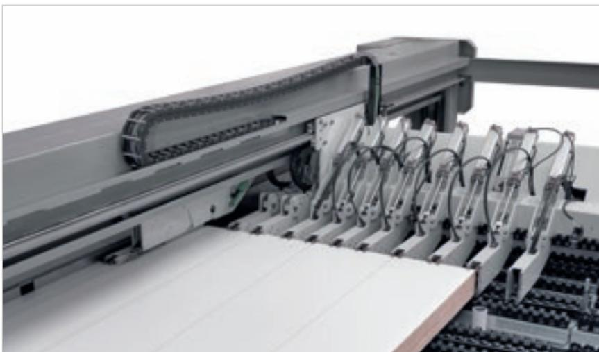
Les deux stations de coupe sont complètement indépendantes dans l'exécution des schémas de coupe grâce à la présence de la zone intermédiaire capable de recevoir un panneau entier. Les deux zones sont entièrement recouvertes de roulettes libres pour préserver la surface des panneaux.
