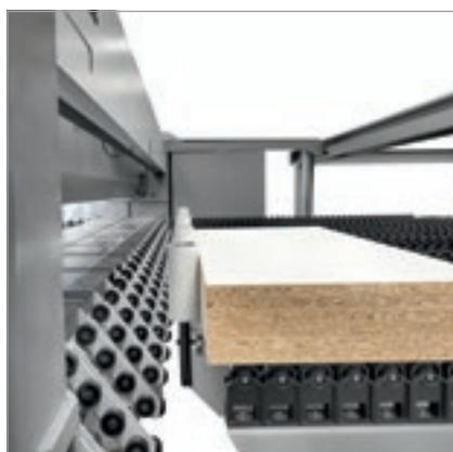
I refili longitudinali vengono evacuati tramite una apposita botola completamente automatica costituita da rotelle folli.
