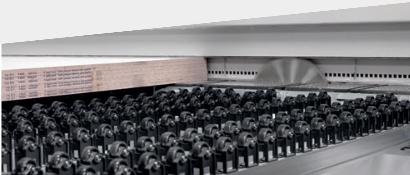
Il doppio pressore, con struttura sdoppiata ed indipendente, consente una pressione omogenea e controllata sul pacco di pannelli da tagliare. L'assenza di aperture per il passaggio delle pinze e crea una vera e propria camera stagna nei tagli di refilo permettendo un'efficace aspirazione delle polveri.
