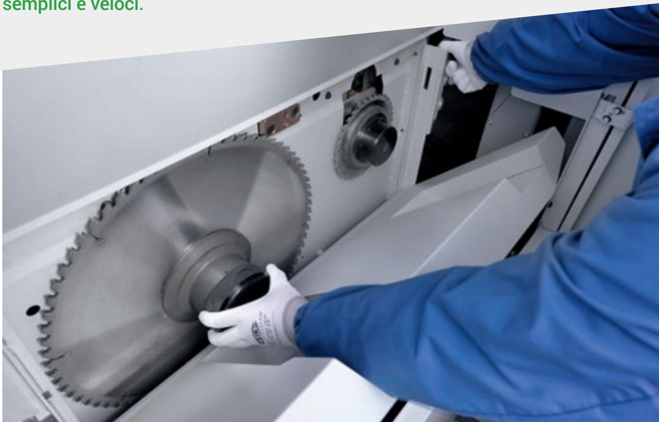
Il sistema **"Quick change"** è il dispositivo più rapido, ergonomico e sicuro per la sostituzione delle lame senza l'utilizzo di utensili.
