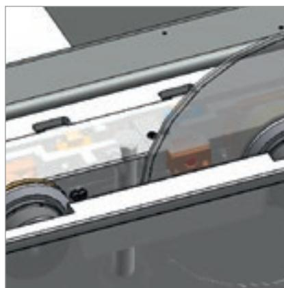
Il dispositivo antisbandamento controlla la posizione e il numero di giri della lama intervenendo sulla velocità di avanzamento. **Massima qualità di taglio, maggiore vita della lama e riduzione dei costi di manutenzione.**
