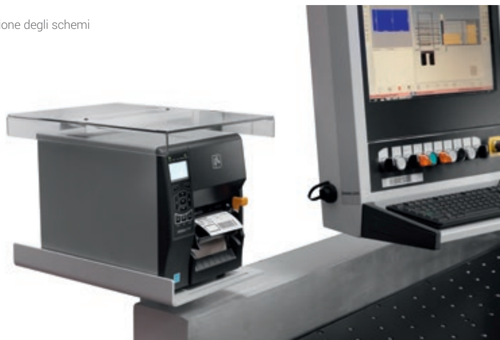
Etichettatura. Uno speciale software consente la creazione di etichette personalizzate e la stampa in tempo reale delle medesime a bordo macchina. Le informazioni disponibili possono essere anche stampate come codice a barre.
