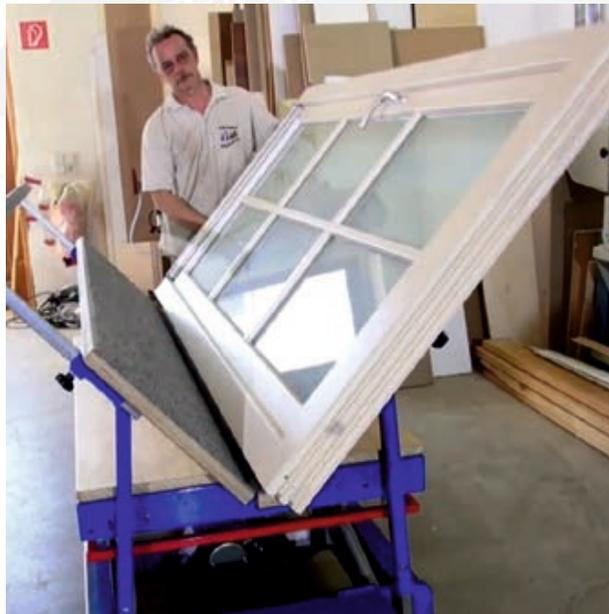
**Der höhenverstellbare Arbeitstisch mit Wendeeinrichtung für schwere Werkstücke.**
