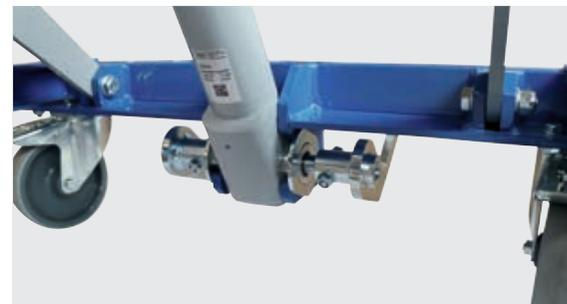
massive Schweißkonstruktion der Zylinderaufnahme (max. Schubkraft 1,2 t)
