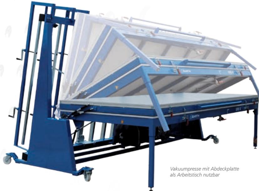
Vakuumpresse mit Abdeckplatte als Arbeitstisch nutzbar
