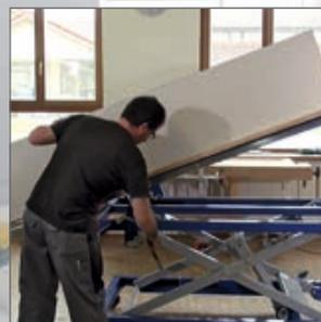
Der neue Arbeitstisch „kippLIFT“ erleichtert durch einfaches Auf- und Abladen den Transport von langen, schweren und sperrigen Teilen wie Türen, Küchenarbeitsplatten, Plattenmaterial etc.
