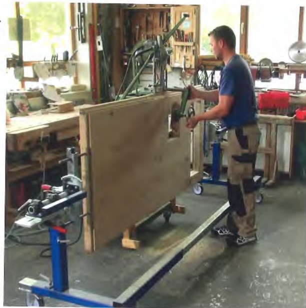
Das wendoSYST kann mit einem Hubtisch bestückt werden
