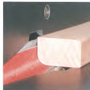
Einfaches Einstellen der Frästiefe
