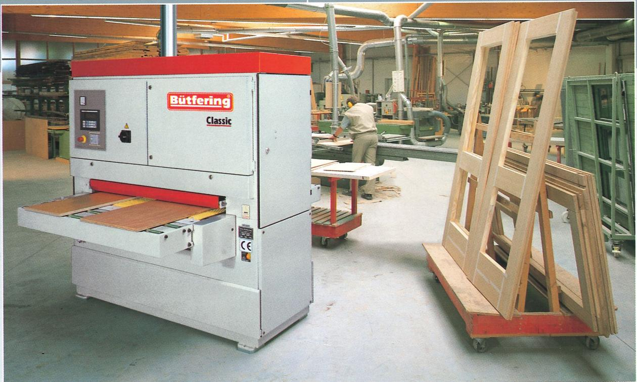
*Classic 111 C – mit einem kombinierten Schleifaggregat mit Kontaktwalze und Gliederdruckbalken – die ideale Standardschleifmaschine im Handwerk und Innenausbau*
