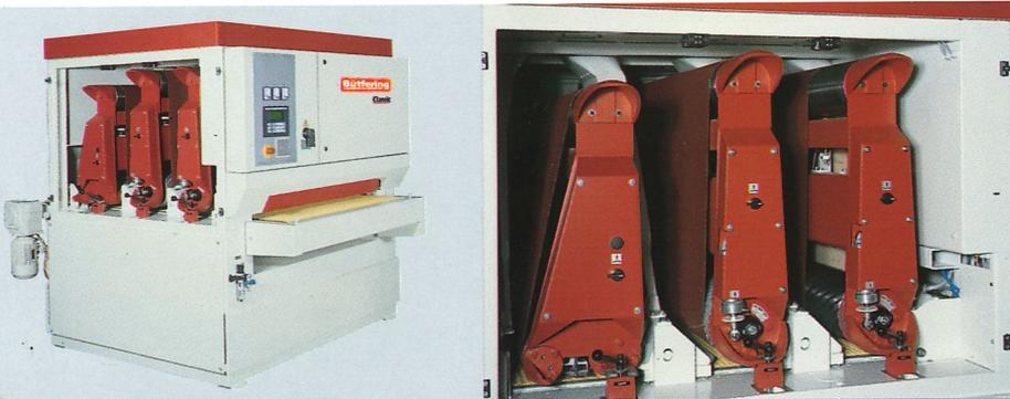
*Classic 313 RRE – Beispiel für eine Breitbandschleifmaschine mit Stahlkontaktwalze, gummierter Kontaktwalze und Gliederdruckbalken. Alle Schleifaggregate sind mit Auflegehilfen für den schnellen und schonenden Schleifbandwechsel ausgerüstet. Die Kontaktwalzen verfügen über Schleifbandkörnungsausgleich und werden automatisch über das Terminal zugestellt.*
