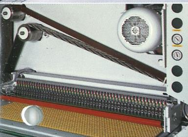
Maschineneinlauf der Classic Q – feingliedrige Segmentierung der robusten Abtastelemente zur Erfassung der Werkstückkonturen – das Querschleifaggregat mit Antriebsmotor 15 kW und Lamellenband
