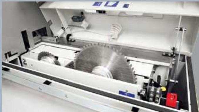
Standardsägewagen mit 2 THK-Führungen
