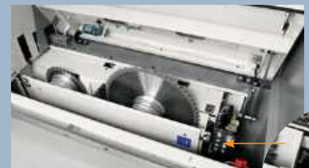
Freigabe der pneumatischen Flansche mittels Wahlschalter
