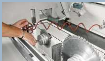
Pneumatische Verriegelung der Haupt- und Vorritzsägeblattflansche
