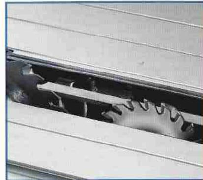
Mit dem Vorritzaggregat (Zubehör) wird die ETS 21 / ETS 23 zur idealen Säge für beschichtetes/furniertes Plattenmaterial. Ausrisse an der Unterseite des Materials werden dadurch verhindert.
