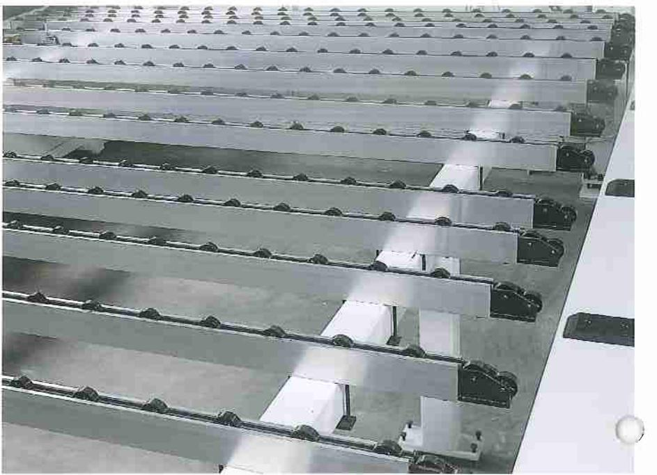
La struttura della macchina è ampiamente dimensionata alle prestazioni in modo da evitare qualsiasi vibrazione che si riflettesse sulla qualità di taglio. Notare il posizionamento in alto della prima guida lineare, vicino al taglio.
