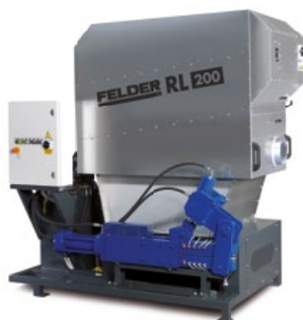
Високи стандарди: Изгаснување на пожар со вода и пневматско чистење на филтерот.
