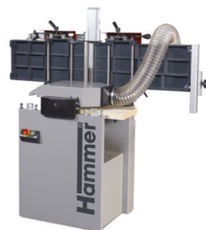
Брзо префрлање од рамнење во длабење. Двојно, симултано подигнување на масите за рамнење
