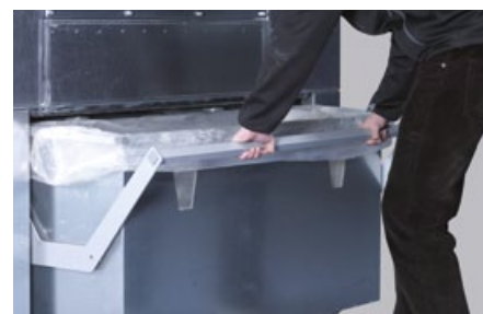
Корпите за собирање на пилевината се позиционирани под машината, обезбедувајќи оптимизирано, еднакво полнење на вреките. Оптимизираниот систем за стегање обезбедува брза промена на вреките за пилевина.
