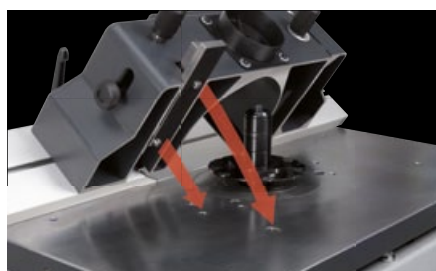
МУЛТИ-систем за подесување, автоматска повторливост
