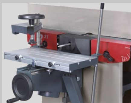
Брзо префрлање од рамнење во длабење. Двојно, симултано подигнување на масите за рамнење
