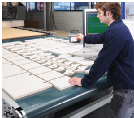
Единица за растоварање со подвижна лента и станица за обележување
