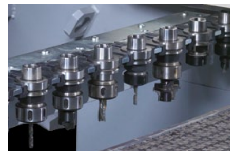
Линиски шаржер за алат кој овозможува брза промена на алатот и обезбедува минимална потрошувачка на компресиран воздух
