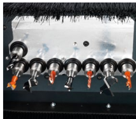
DH 8 глава за бушење, со 8 вертикални вретена - или DH12 глава за бушење, со 12 вертикални вретена - или DH16 глава за бушење со 12 вертикални и 4 хоризонтални вретена
