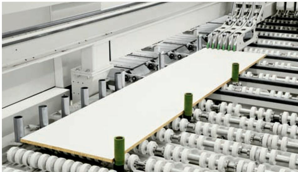
Allineatori laterali su pressore e su piano macchina trasversale con corsa ottimizzata (**brevetto GABBIANI**)
