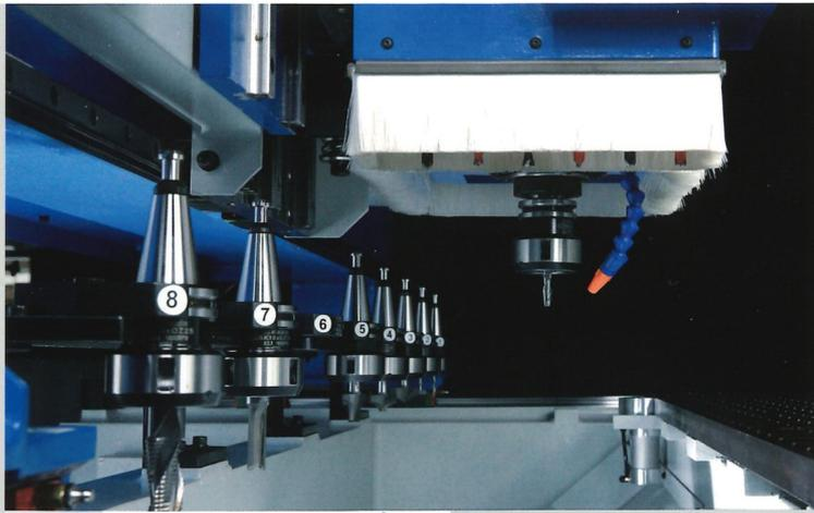
**Automatischer Werkzeugwechsel und hochpräzise Elektroschneidspindel**
