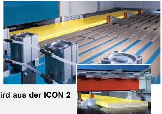
Durch Ergänzung der Maschine um ein Postformingaggregat wird aus der ICON 2 eine echte Postforming-Strangsäge (Option).
