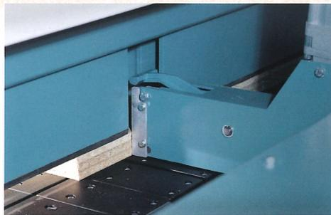
Auflagetisch unterhalb des Schiebers mit Rollenprofilen zur Verhinderung von Schäden an Platten mit empfindlichen Oberflächen.
