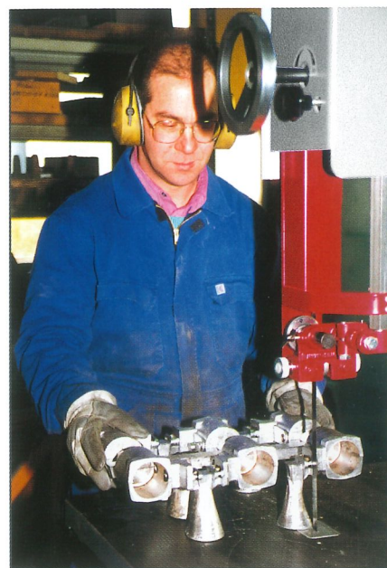
Abtrennen von Angussstrichern bei Alu-Sandguss
