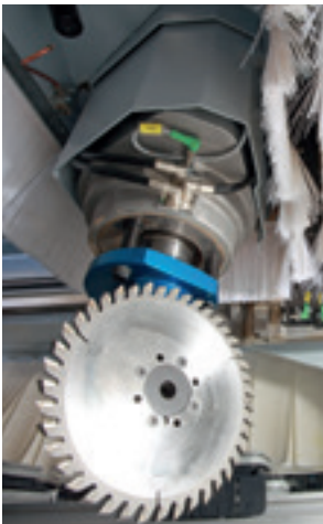
C-Achse (0-360°) für den Einsatz von Aggregaten
