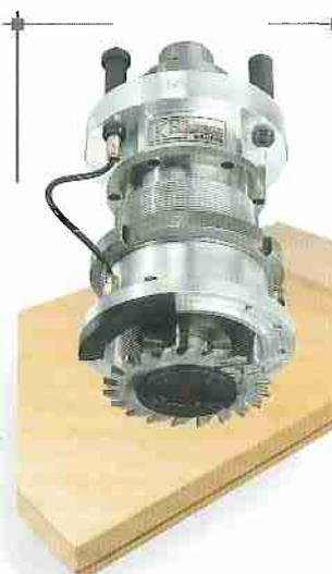
**HSK 63 Fräsen vertikal mit getasteter Kufe**
