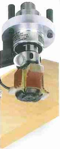
**HSK 63 Adapteraufnahme für Schleifkörper**
