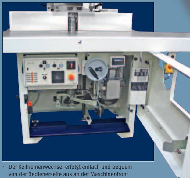
· Der Keilriemenwechsel erfolgt einfach und bequem von der Bedienerseite aus an der Maschinenfront
