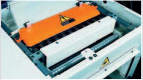
· schrägverzahnte Stahleinzugsrollen für einen konstanten und gleichmäßigen Holzeinzug
