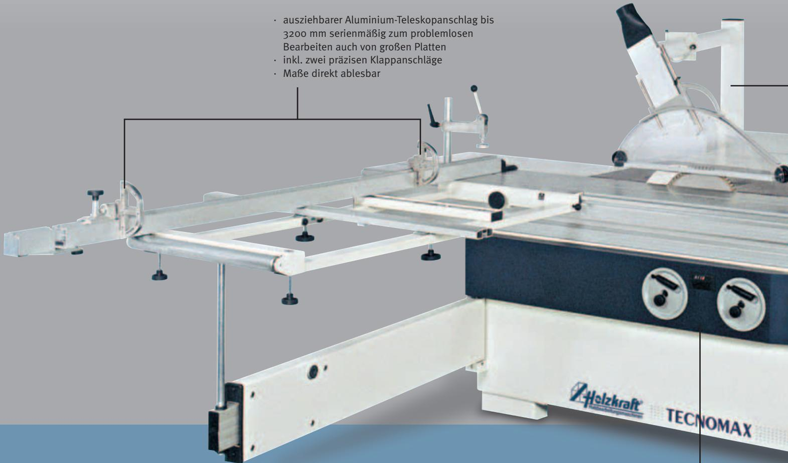
Version "F 32": mit Alu-Formatschiebeschlitten 3200 mm
