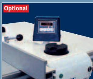
Option "elektronische Positionsanzeige am Parallelanschlag"
