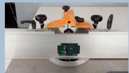
Abb. zeigt Sicherheits-Systemanschlagbacken angebaut an der Tischfräse
