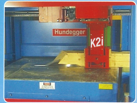
Auskehlungen oder Abgratungen - vollautomatisch und millimetergenau.
