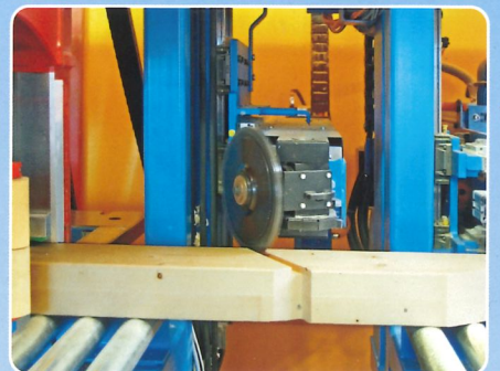
Mit der von 0 - 180° schwenkbaren Längs- und Quernutfräse lassen sich Stellbrettnuten und Längsnuten in jedem Winkel vollautomatisch rationell herstellen.
