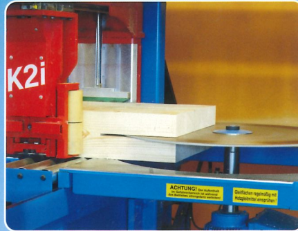
Schlitzte bis zu 350 mm Tiefe werden mit der Horizontalsäge sauber und schnell ausgeführt.
