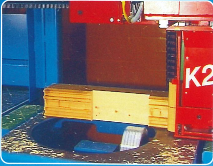
Ausblättungen in jedem Winkel auf allen 4 Bauteilseiten.
