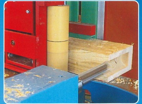
NHT-Verbindung ohne Zusatzaggregat.
