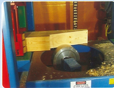
Gerberstöße aller Art werden schnell und maßgenau gefräst.
