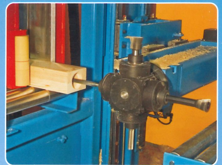
Revolverfräse - vertikal. Aufnahme von bis zu 4 verschiedenen Werkzeugen, wie Bohrer, Fingerfräser, Walzenfräser oder Schwalbenschwanzfräser.
