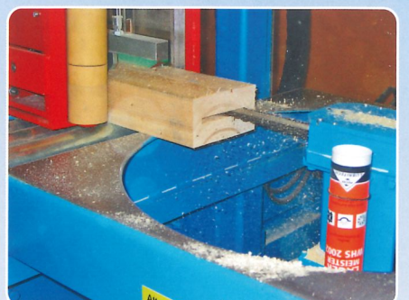
Verdeckte oder winkelige Schlitz sind mit dem 360° schwenkbaren Kettenschlitzgerät einfach zu realisieren.
