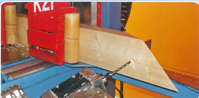
Bohrungen an 5 Bauteilseiten mit beliebigem Winkel und Neigung.
