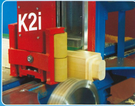
Das Holz wird direkt an der Bearbeitung gespannt.
