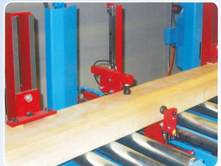
Querschnittsvermessung zur automatischen Erkennung und Korrektur der Rohholz-abmessungen.
