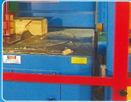
Hexenschnitte mit beliebigen Schnittwinkeln und Schnitttiefen.
