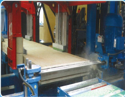
Mit dem geführten Kettenschlitzgerät sind Schlitzte bis zu einer Bauteilbreite von 1250 mm in beliebiger Länge, sowie verdeckte Schlitzte auf der Anschlagseite genau und schnell zu fertigen.
