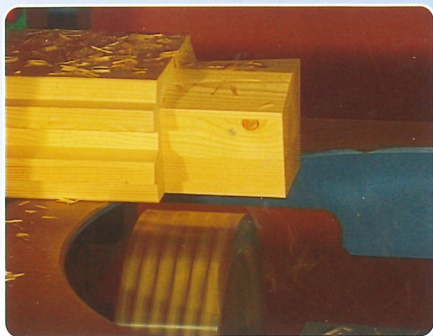
Auch profiliertes Holz wird verletzungsfrei transportiert und bearbeitet, z.B. beim Fräsen von Blockbohlen.
