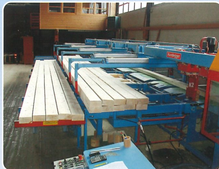
Hydraulischer Hubtisch mit automatischer Paketentstapelung.
