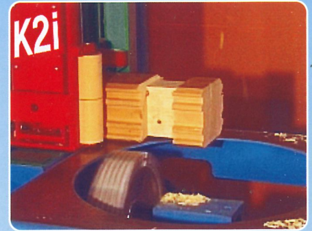
Verschiedene Blockhauseckverbindungen sind als Holznotenpunkte hinterlegt.
