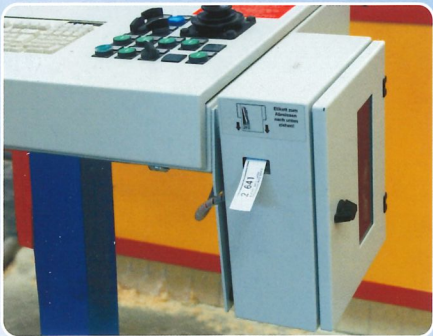
Pultdrucker für Etiketten mit der Angabe von Bauteilname, Bauteilnummer usw..
