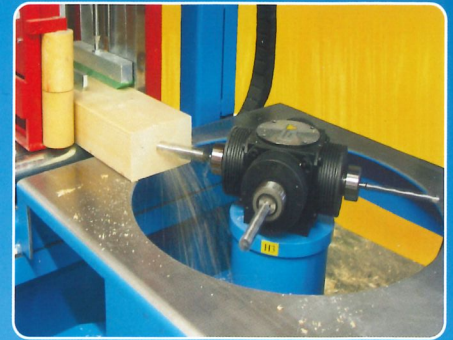
Revolverfräse - horizontal. Aufnahme von bis zu 4 verschiedenen Werkzeugen, wie Bohrer, Fingerfräser, Walzenfräser oder Schwalbenschwanzfräser.
