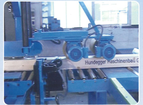
Tintenbeschriftungssystem - autark. Beschriftungen und Markierungen in der Nebenzeit.
