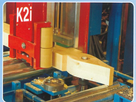
Bohrungen verschiedenster Größe sowie auch Sacklochbohrungen.
