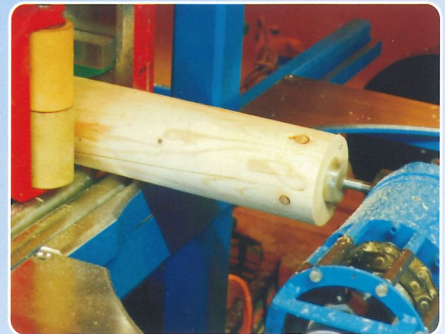
Bis zu 10 unterschiedliche Werkzeuge werden im Werkzeugmagazin aufgenommen und vom EKP-Programm verwaltet. Je nach Anforderung an das zu bearbeitende Bauteil, wird das entsprechende Werkzeug automatisch aus dem Magazin eingewechselt. Durch die im EKP hinterlegten Kenndaten der einzelnen Werkzeuge, wird vom Programm automatisch die zugehörige Drehzahl übernommen.
