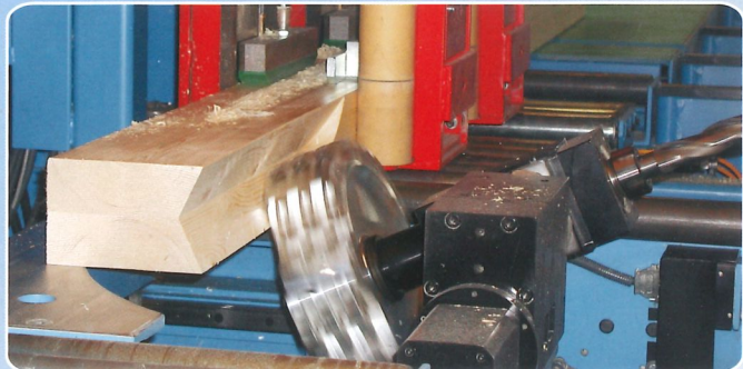
Auskehlen oder Abgraten ohne Restholz. Fräsungen in jedem beliebigen Winkel und in jeder Neigung.
