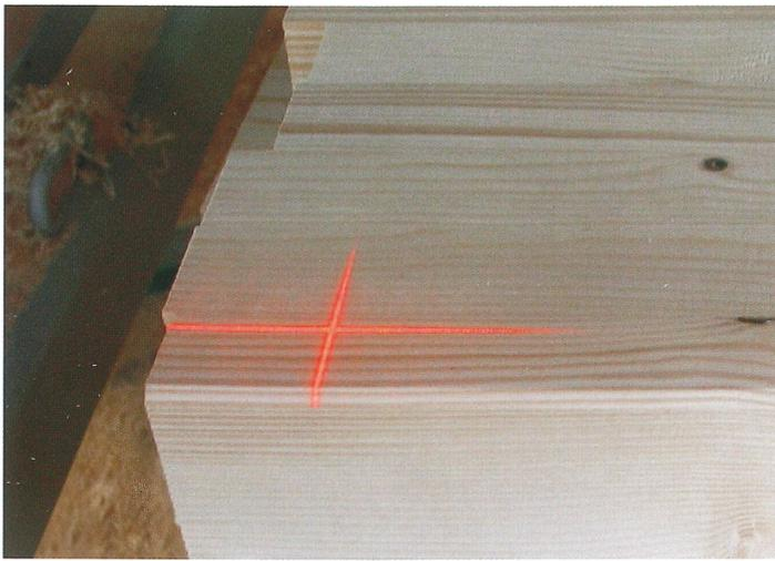
En mode de fonctionnement normal, les pièces de grande surface sont ajustées automatiquement sur le plateau d'usinage grâce aux butées mobiles. Les pièces peuvent cependant aussi être posées comme vous le désirez. La position est alors déterminée par un pointeur laser et calculée automatiquement dans le programme. Le réticule du pointeur laser est saisi par une caméra et l'opérateur peut le voir sur l'écran.
