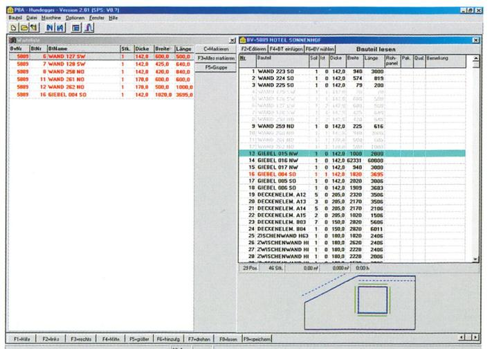
La commande utilise la pièce automatiquement selon un ordre optimal. L'utilisation d'une commande multiprocesseur permet d'avoir un fonctionnement automatique de la machine et un décompte automatique ainsi qu'une gestion des quantités de pièces déjà terminées.
