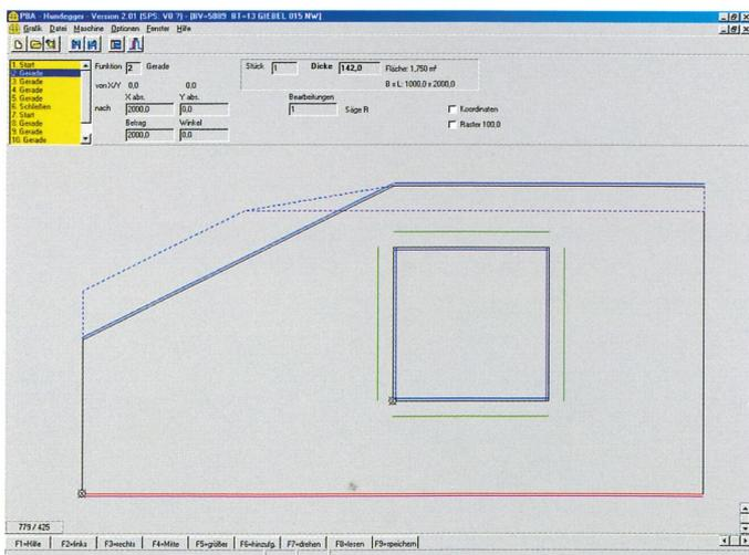
Le programme PBA de Hundegger se caractérise par une simplicité de saisie et de manipulation pour l'opérateur. Les données d'usinage peuvent être reprises de programmes de DAO ou être directement rentrées ou modifiées sur la machine par l'opérateur. Pour ce faire, il dispose d'une interface graphique simple à utiliser.
