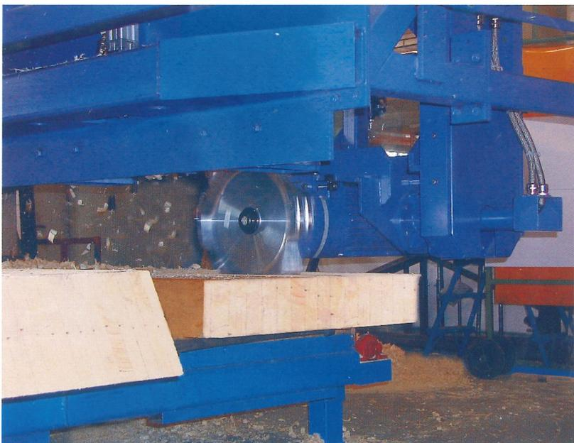
Pour l'usinage de très grandes pièces, comme par exemple des poutres collées, on dispose d'une autre fraiseuse à 5 axes avec un moteur d'une puissance de 38 kW. La fraiseuse peut être équipée de différents outils de fraisage, de lames de scie circulaire ou de forets. Grâce au mandrin rapide, les temps d'équipement sont raccourcis au strict minimum lors des changements d'outils.
