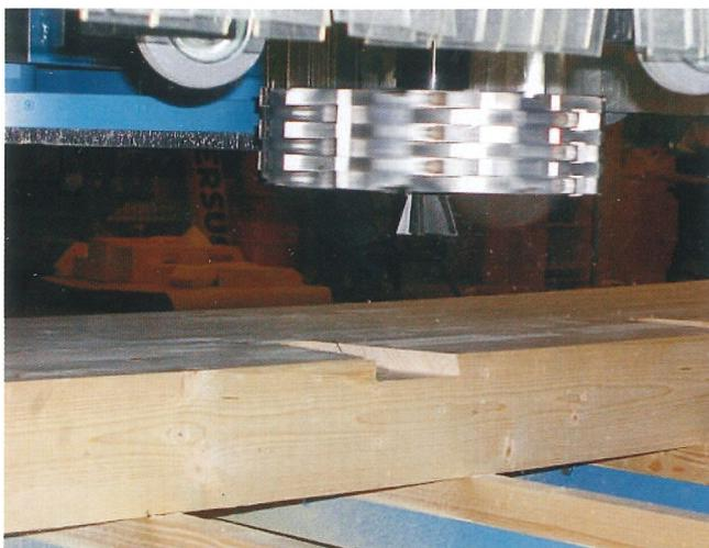
La fraiseuse à 5 axes, avec un moteur de 15 kW, est équipée en standard d'une tête de fraisage à plaquettes réversibles de Ø 350 x 100 mm ainsi que d'une fraise à queue et à gorge de Ø 40 x 160 mm.
