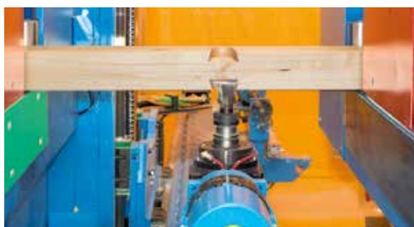
Une table mobile en sortie peut se déplacer dans le sens Y de la longueur et garantit que la pièce soit toujours maintenue aussi près que possible de l'usinage à réaliser. Toute vibration inutile est ainsi évitée au moment de l'usinage. Tout ceci combiné avec la vitesse de rotation rapide de l'agrégat ROBOT permet de fabriquer avec des états de surfaces de qualité visible.
