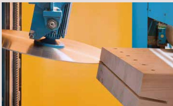
Contrairement à une solution d'une scie pivotante sous plateau, la lame peut couper sous la position 0 et réaliser des entailles sous n'importe quel angle et dans toutes les épaisseurs requises
