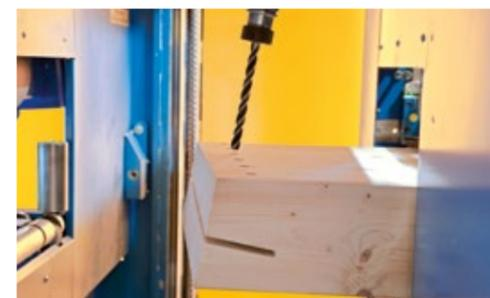
Una tavola mobile in direzione longitudinale sul lato di uscita assicura che l'elemento viene bloccato stretto per evitare le vibrazioni durante la lavorazione. In combinazione con l'alto numero di giri dell'aggregato ROBOT si ottengono superfici di alta qualità.
