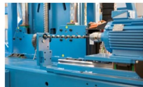
Opzionalmente è possibile installare fino a 2 trapani orizzontali. Così è possibile effettuare diverse forature senza cambiare utensile con un massimo di profondità di 525 mm.
