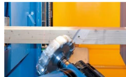
Grazie alla particolare costruzione del macchinario, l'aggregato ROBOT, estremamente stabile, riesce a lavorare su tutti i 6 lati dell'elemento anche in tutte le angolazioni ed inclinazioni. Non serve più girare il pezzo o addirittura ripetere il passaggio per le sezioni più grandi. Il risultato è l'assoluta precisione.
