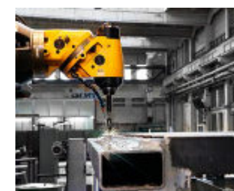
Przygotowanie ramy na wielkoformatowym centrum obróbczym CNC
