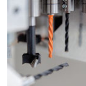
Agregat wiertarski na różne wiertła - w tym puszkowe
