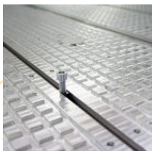
Stół roboczy aluminiowy - rastrowo-t-rowskowy
