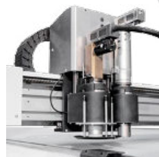
Możliwość zastosowania kilku różnych narzędzi w jednym cyklu obróbki
