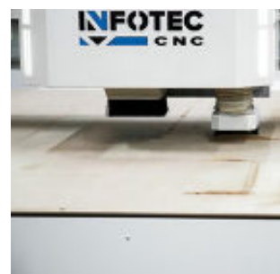
Automatyczne czyszczenie pola roboczego
