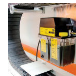
Centralne smarowanie ruchomych podzespołów
