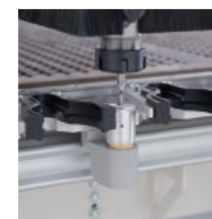
Automatyczny pomiar długości narzędzia
