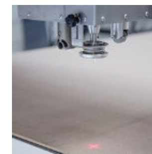
Laserowe wyznaczenie punktu zerowego
