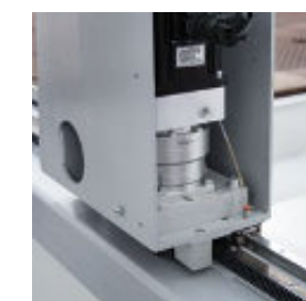
Serwonapęd AC z planetarną przekładnią jednostopniową oraz listwa skośnie szlifowaną i układ liniowy.
