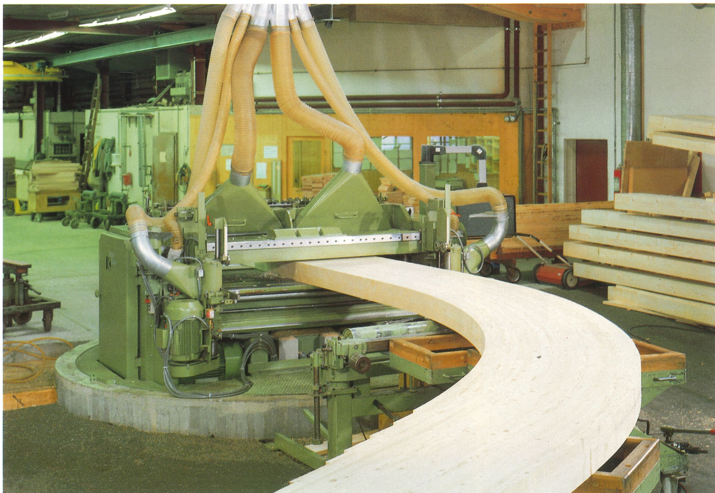
Hobeln von geraden und gekrümmten Leimbindern.
